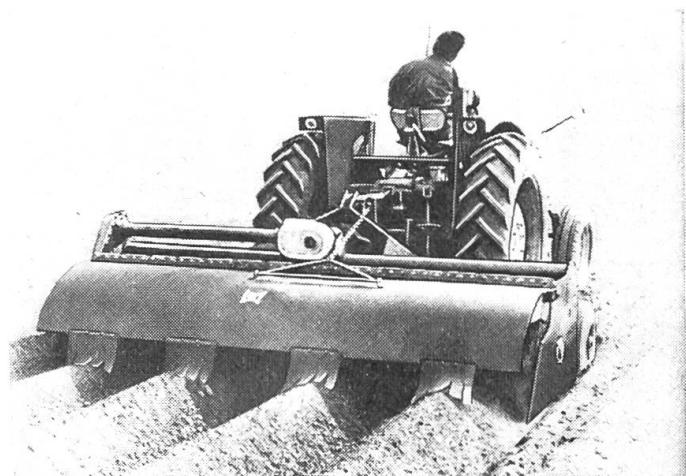
Weiter werden die Dämme so aufgebaut, dass diese mit feiner Erde abgedeckt sind, wodurch die Bodenfeuchtigkeit sich besser halten kann. Die Kartoffeln finden durch das Festhalten der Bodenfeuchtigkeit maximale Wachstumsverhältnisse vor. Außerdem bereitet die grobe Bodenstruktur in den Furchen einen besseren Wasseraufschwung.
