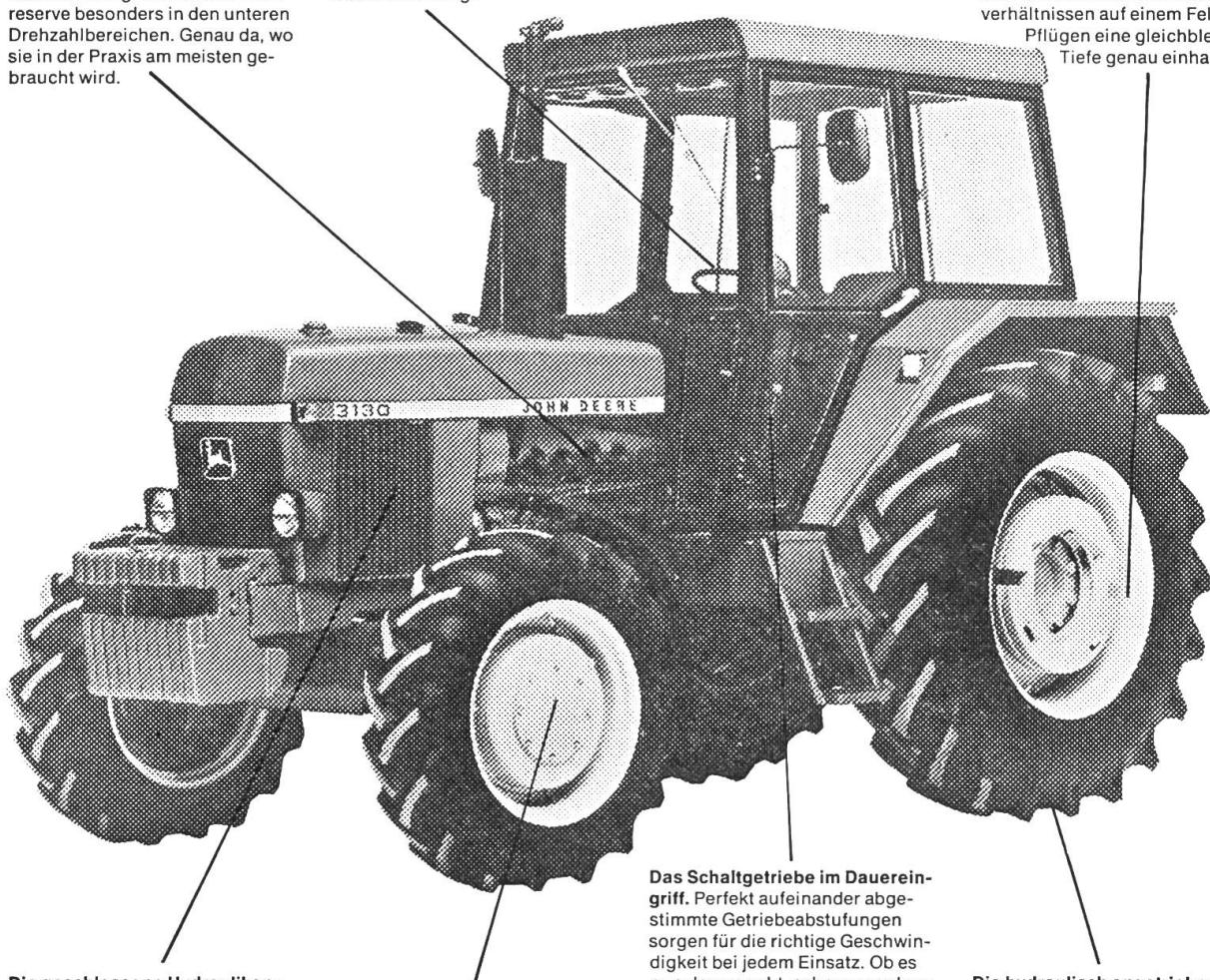
**Die geschlossene Hydraulikanlage.** Eine Außenpumpe liefert den benötigten Arbeitsdruck sofort und ohne Verzögerung, arbeitet aber nur, wenn dieser Druck auch abgefragt wird. Getriebe und Hydrauliksystem werden mit der gleichen Hydraulikflüssigkeit betrieben.
