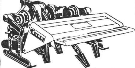
Die neue Celli-Spatenmaschine besitzt ein 4-Gang-Getriebe, das eine flexible Arbeitsgeschwindigkeit erlaubt. Es sind verschiedene Typen erhältlich: mit Arbeitsbreiten von 1.10-2.25 m und mit variablen Arbeitstiefen von 20-40 cm. (3-Punkt-Aufhängung). Keine Furchen und keine Bodenverdichtungen mehr.
