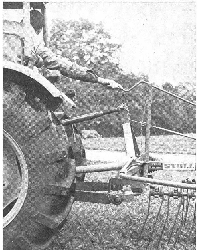
Abb. 4: Höhenverstellmöglichkeiten versehen ihren Zweck nur dann, wenn sie für den Fahrer jederzeit leicht erreichbar sind.
