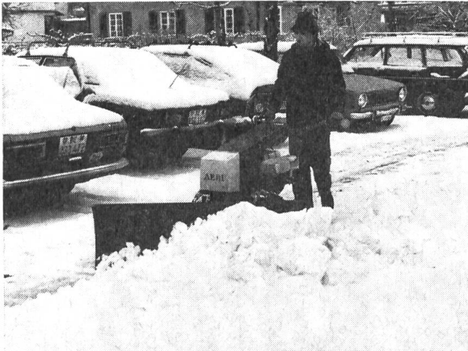
Abb. 4: AEBI KM 51, dank Geräte-Schnellanschluss, rasch mit einem Schneepflug ausgerüstet.
