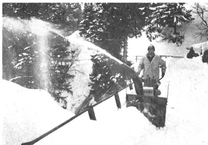
Abb. 3: AEBI KM 51 die vielseitige Schneeräummaschine, hier beim Schneefräsen.
