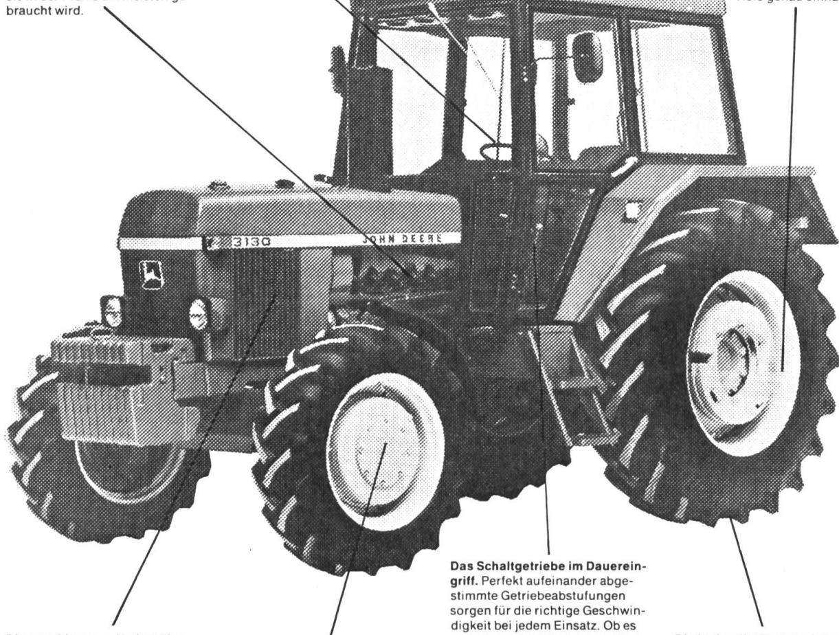
**Die geschlossene Hydraulikanlage.** Eine Außenpumpe liefert den benötigten Arbeitsdruck sofort und ohne Verzögerung, arbeitet aber nur, wenn dieser Druck auch abgerufen wird. Getriebe und Hydrauliksystem werden mit der gleichen Hydraulikflüssigkeit betrieben.
