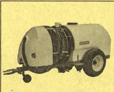
1. Der frontseitig angeordnete Gebläseteil ermöglicht jetzt auch das vollständige Aus-spritzen der Baumreihen beim Wenden. Zudem wird eine optimale Manövriergängigkeit erreicht.
