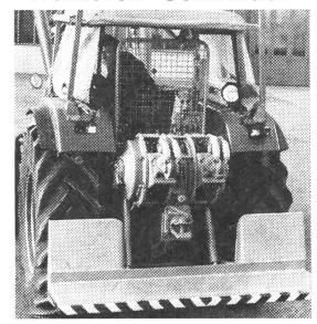
Ritter-Seilwinden für Forstwirtschaft und Feldbearbeitung. Schwere, robuste Bauart, Modelle von 3–7 t, für Traktoren von 35–100 PS, mit breitem oder schmalem Rückeschild. Fixmontiert, montiert an die Dreipunktaufhängung oder auf Wunsch mit Schnell-Montageplatte. Wir senden Ihnen gerne unverbindlich die gewünschten Prospekte.
