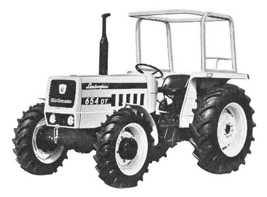
Typen mit 47, 56, 67, 82, 110 DIN-PS, vor allem mit Allradantrieb Schmalspurtraktor speziell für Obst- und Weinbau, 47 DIN-PS, mit und ohne Allrad-Antrieb
