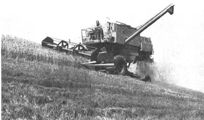
Hangneigungen bis zu 40 Prozent in Schichtlinie, bis zu 20 Prozent bergauf und bis zu 10 Prozent bergab werden beim CLAAS-Hangmähdrescher automatisch ausbalanciert.
