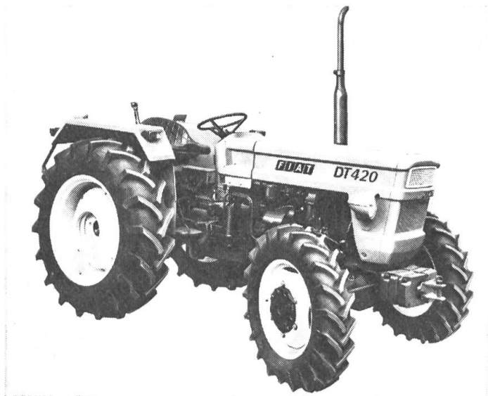
Der neue FIAT-Traktor DT 420, 42 DIN-PS, mit Vierradantrieb.
