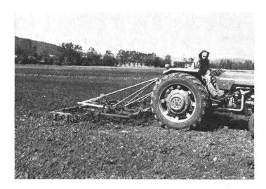
Abb. 3 und 4: Für die Saatbettvorbereitung in leichteren Böden haben sich Gerätekombinationen gut bewährt; bei weniger günstigen Arbeitsbedingungen sind hingegen zapfwellengetriebene Geräte, wie z. B. Kreiseleggen, vorzuziehen (Abb. 4).
