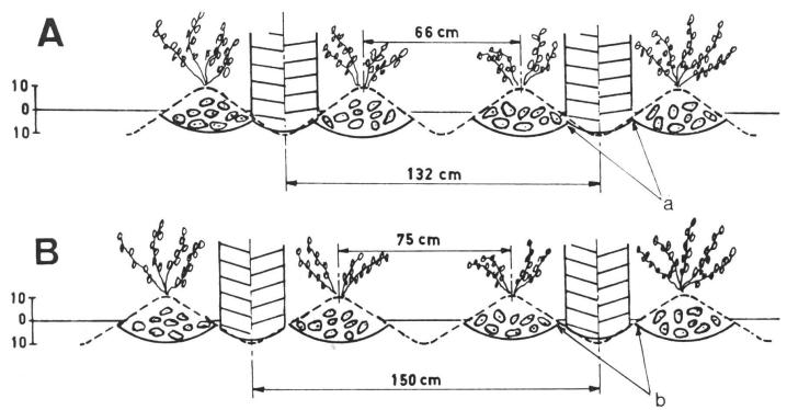
Abb. 6: Die modernen Traktoren mit 11 Zoll-Bereifung sind für die 66 cm-Reihen zu breit (A). Bei 75 cm Reihenabstand (B) besteht weniger Gefahr, dass die Dammwände durch die Räder gepresst werden (a bzw. b).
