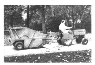
Die Anhänge-Kehrsaugmaschine Typ Europa mit den vielen Vorteilen wird Sie begeistern, sehr saubere, staubfreie Arbeit, grosser Sammelbehälter, geeignet für grosse Rasenflächen wie für die Trottoirreinigung. An allen Zugfahrzeugen mit Zapfwellenantrieb verwendbar.
