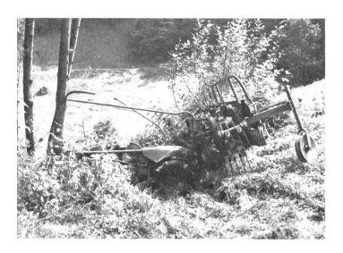
Ein Beispiel dafür, wie unheilvoll sich selbst bei mässiger Hangneigung die Verkettung unglücklicher Umstände auswirken kann: «Beim Rückwärtsfahren gerieten die Räder des Motoreinachsers in eine Bodenvertiefung. Der eine Holm, an dessen Ende der abrundende Schutzdeckel fehlte, schlug auf dem Oberschenkel des Maschinenführers auf, so dass die Beinschlagader platze. Der Verletzte verschied zufolge des hohen Blutverlustes in der Nähe der Unfallstelle».
