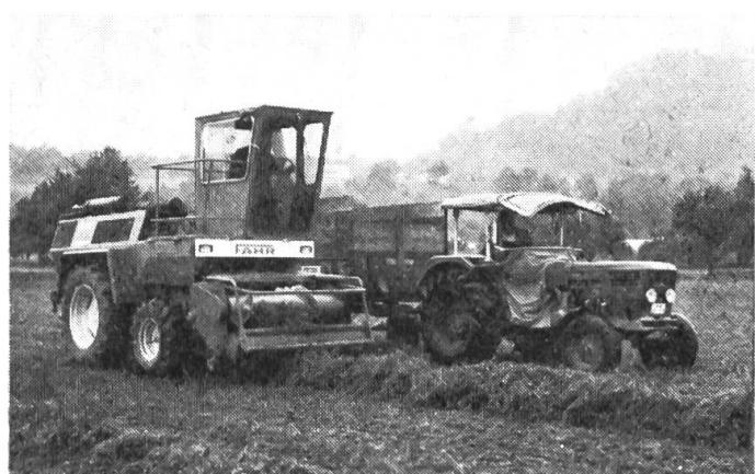
Beispiele sind hier der hydrostatische Fahrantrieb, die hydrostatische Servo-Lenkung oder die komfor-table integrierte Fahrerkabine, auf der sich der Fahrer wohlfühlt.
