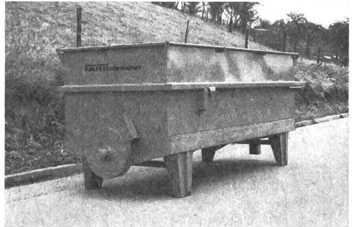
Abb. 2: Abgestellter Fahrcontainer-Klärschlammstreuer mit Sicht auf das Auswurfgehäuse (bei geschlossener Klappe).
