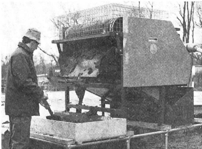
Der rohe, landwirtschaftliche Kot wird in dem Behälter oberhalb einer in Drehung befindlichen, gelochten Trommel eingegeben. Die Flüssigkeit fliesst durch die Trommel hindurch in einen Sammeltrog. Während sich die Trommel dreht, werden die Feststoffe
