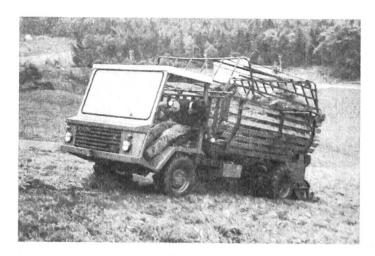
Abb. 3: TR 1800 mit Heckladegerät.
