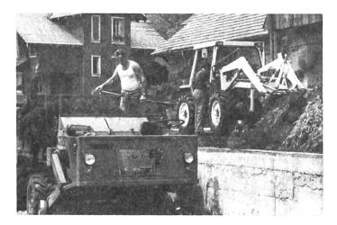
Abb. 4: UT 5000 mit Mistgabel beim Beladen eines TR 1600.
