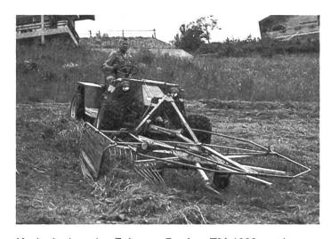
Kreiselschwader Fahr am Bucher TM 1000 an der Fronthydraulik montiert.
