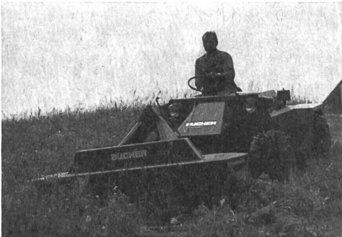
Bucher TM 1000, 52 PS, mit Fahr KM 22 2-Kreiselmäher, 1,65 m Schnittbreite.
