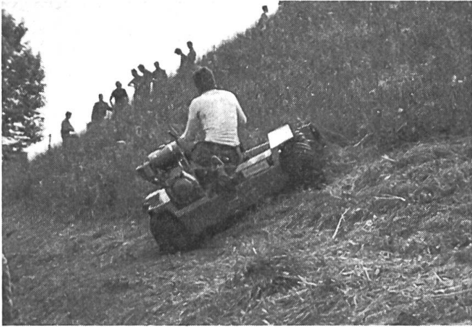
Die Abdrift des AR 4 war teilweise so stark, dass eine saubere Arbeit nicht mehr gewährleistet war . . .
