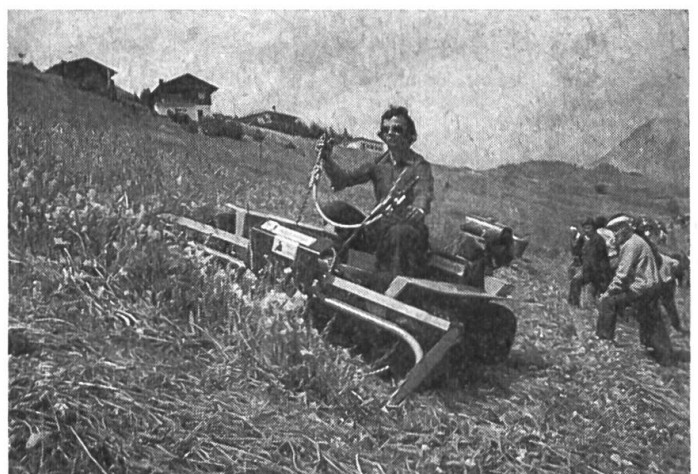
Agroma AR 4, 12 PS, mit Busatis-Doppelmesser-Frontmähwerk, 1,6 m Schnittbreite. Lenkung des Fahrzeuges mittels Lenkbremsen.
