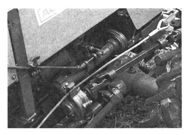
Messerantrieb des Wiesel 222. Durch Spannen des Keilriemens wird der Kraftschluss mit der Kurbelwelle hergestellt.
