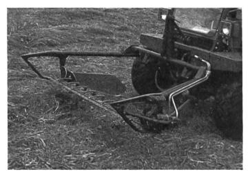
Der ölhydraulische Antrieb stellt technisch die perfektere, wenn auch teurere Lösung dar.
