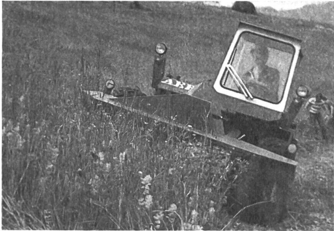
Aebi Terratrak TT 77, 43 PS, mit PZ 2-Kreiselmäher, 1,65 m Schnittbreite.
