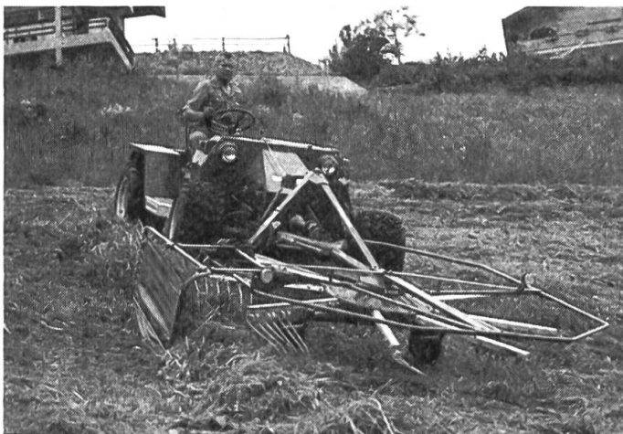
Kreiselschwader Fahr am Bucher TM 1000 an der Fronthydraulik montiert.
