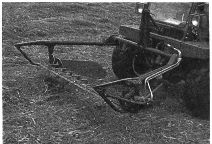
Der ölhydraulische Antrieb stellt technisch die perfekte, wenn auch teurere Lösung dar.
