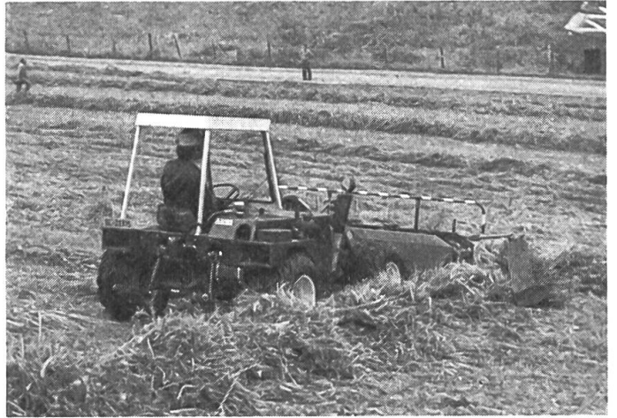
Bandrechen «Heublitz» am Aebi Terratrak TT 77 ebenfalls im Frontanbau.
