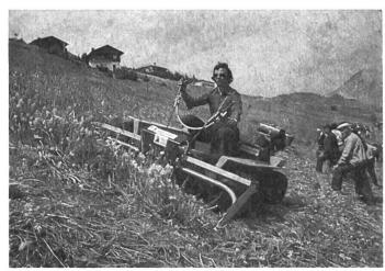
Agroma AR 4, 12 PS, mit Busatis-Doppelmesser-Frontmähwerk, 1,6 m Schnittbreite. Lenkung des Fahrzeuges mittels Lenkbremsen.
