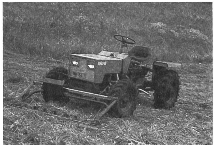
Wiesel 222, 22 PS, mit Doppelmesser-Frontmähwerk, 1,8 m Schnittbreite.
