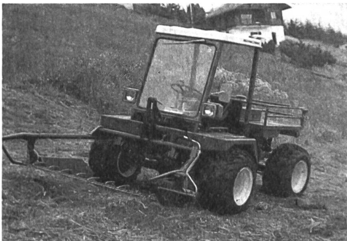
Reform Metrac 3000, 35 PS, mit Busatis-Doppelmesser-Frontmähwerk, 2 m Schnittbreite.
