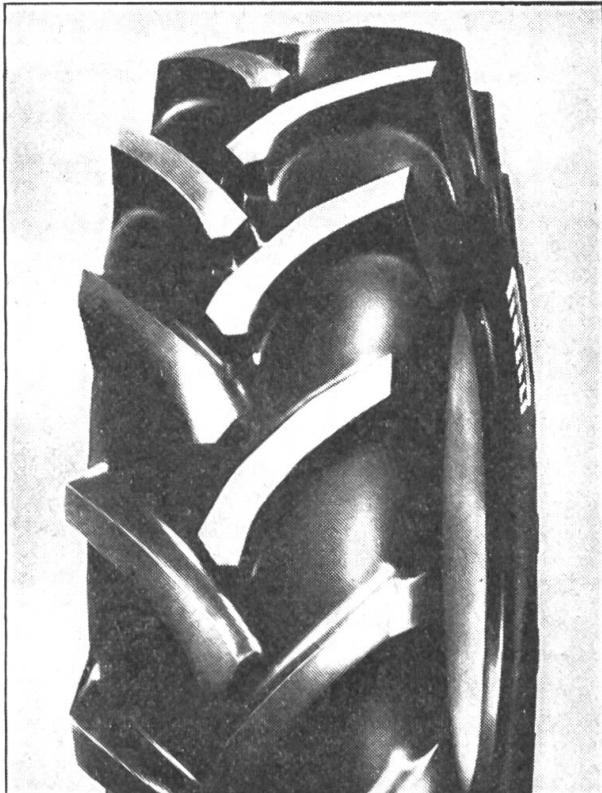
Sritische Landwirte entscheiden sich für den Pirelli Cinturato agricolo TM52. Im tiefen Boden wie am steilen Hang packt er kräftig zu! Sein Profil und sein Gürtelunterbau\* verleihen ihm die bekannte, hervorragende Traktion. Mit diesem Reifen sparen Sie Zeit und Geld, denn der geringere Rollwiderstand erlaubt leichteres Arbeiten und reduziert den Kraftstoffverbrauch. Die besonders zähe, abriebfeste Gummimischung gewährleistet ein überlanges Leben! TM 52!
