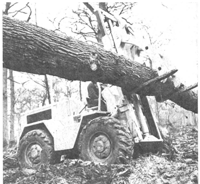
SOVEMAT TE 25 mit Baumklammer (max. Oeffnung 1,40 m) Bild: Hulftegger & Co. AG, Stäfa
