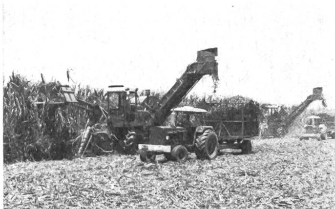
In Kuba begann Claas in Zusammenarbeit mit kubanischen Zuckerrohr-Experten vor über 10 Jahren auch mit der Entwicklung. Seit 1971 wird der «Libertadora» bereits in Serie gebaut. Er leistet je Stunde zwischen 30 und 60 Tonnen gereinigtes Zuckerrohr.
