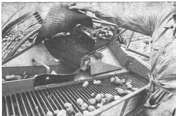
Abb. 6: Gute Trennergebnisse verlangen eine optimale Einstellung der Gummifingerbänder.
