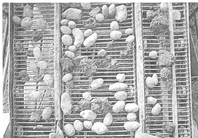
Abb. 5: Bildausschnitt der Filmkamera. Die Filmaufnahmen ermöglichten ein späteres Auszählen der Rodegutteile.
