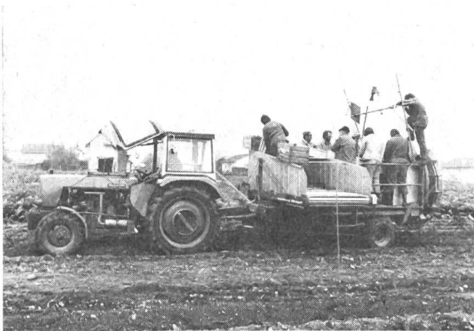
Abb. 2: Messtraktor (Zugkraft- und Drehmomentmessung) mit Vollernter im Versuchseinsatz.
