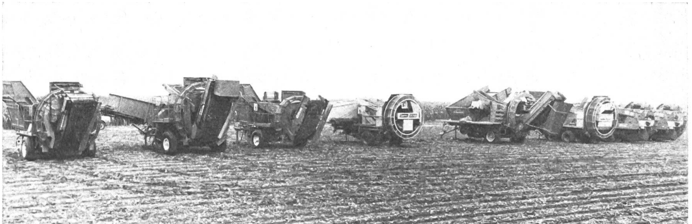
Abb. 1: Die eingesetzten Kartoffelvollernter unterscheiden sich vor allem im System und in der Grössenklasse. Von links nach rechts bzw. von rechts nach links: Hassia KRM-BR und KRM-B, Samro Super, Wisent RM-R, Samro SCRB, Grimme Standette, -Super SG und -Standard (Wisent SRB ist nicht in der Abbildung enthalten).
