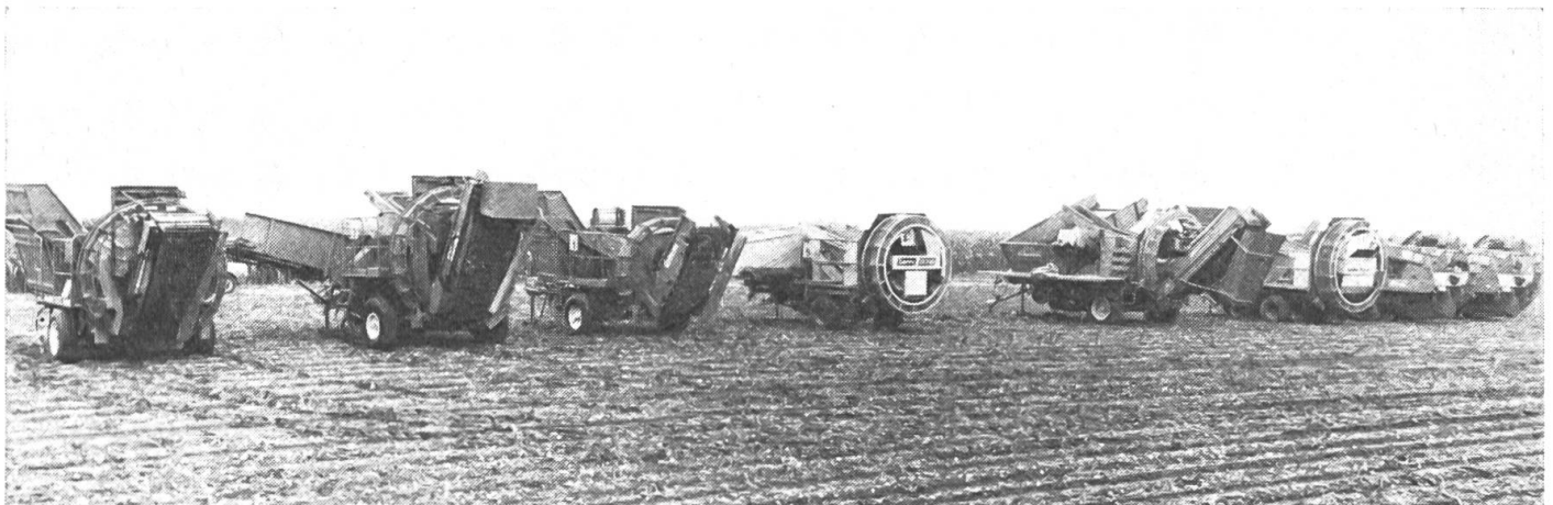
Abb. 1: Die eingesetzten Kartoffelvollernter unterscheiden sich vor allem im System und in der Grössenklasse. Von links nach rechts bzw. von rechts nach links: Hassia KRM-BR und KRM-B, Samro Super, Wisent RM-R, Samro SCRB, Grimme Standette, -Super SG und -Standard (Wisent SRB ist nicht in der Abbildung enthalten).
