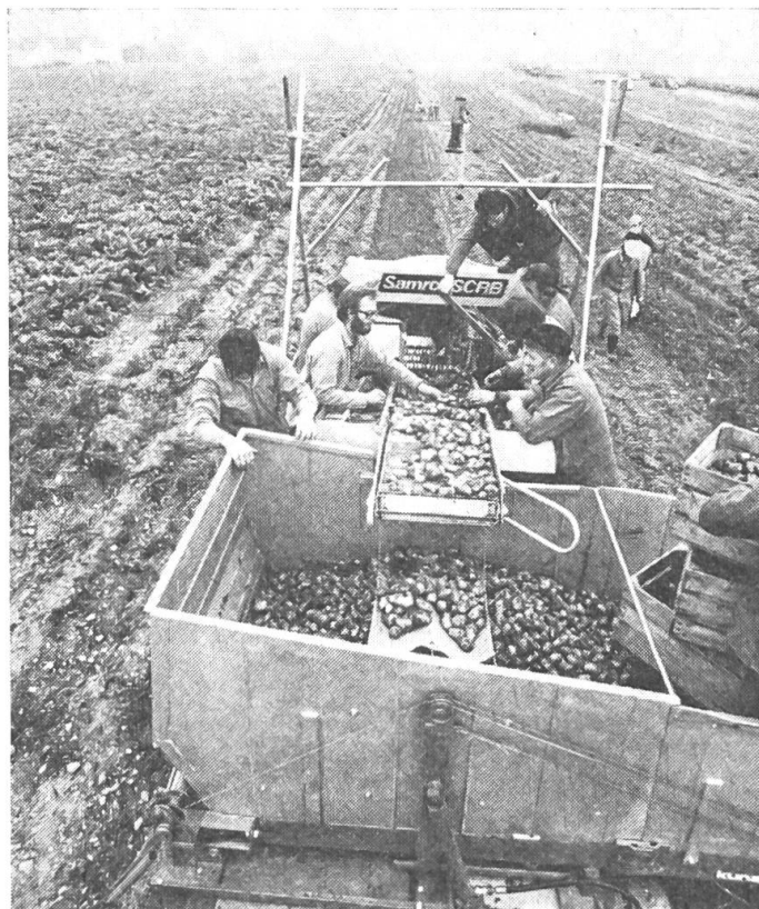
Abb. 4: Aufgrund von Filmaufnahmen am Einlauf der Verlesebänder konnten die Stück-Verhältnisse der richtig und falsch geleiteten Rodegutteile bestimmt werden. Am Ende des Hauptverlesebandes wurden mittels ausgepolsterter Harassen Knollenproben entnommen und später einem Schältest unterzogen.
