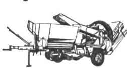
**RM** für mittlere bis grössere Betriebe; mit Ladefläche oder mit Kipp-Bunker, Inhalt 1300 oder 1600 kg, oder mit Rollboden-Bunker, 1800 kg.
