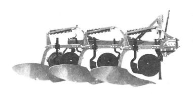
Der neue Pflug kann mit einer ganz neuen, vollautomatischen Steinsicherung (die auch nachträglich eingebaut werden kann) ausgerüstet werden. Jetzt kann ohne anzuhalten und ohne Aerger gepflügt werden. Wenn der Pflugkörper an einen grossen Stein oder eine andere Behinderung stösst, geht der Körper automatisch hoch. Nach Passieren des Hindernisses geht der Körper wieder automatisch in die Arbeitsstellung zurück.
