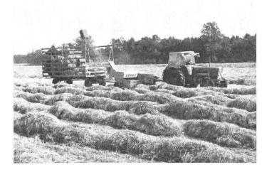
Abb. 2: Für die Bergung von Mähdrescherstroh und neuerdings zunehmend auch von Heu ist die Hochdruck-Presse die arbeitssparende Lösung. Mit angebauter Ballenschleuder (unser Bild zeigt die Claas Markant 50) werden die Ballen automatisch geladen, ein Verfahren, das sich immer mehr durchsetzt.
