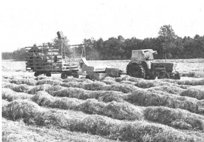
Abb. 2: Für die Bergung von Mähdrescherstroh und neuerdings zunehmend auch von Heu ist die Hochdruck-Presse die arbeitssparende Lösung. Mit angebauter Ballenschleuder (unser Bild zeigt die Claas Markant 50) werden die Ballen automatisch geladen, ein Verfahren, das sich immer mehr durchsetzt.
