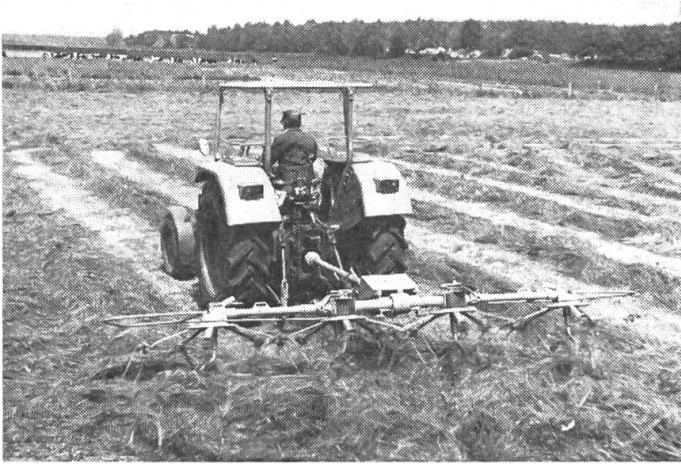
Abb. 1: Der Wirbelwender Claas W 450 ist eine Spezialmaschine zum Zetten und Wenden von Halmfutter. Gleichmässig und locker werden die Mähswaden über die gemähte Fläche verteilt. Trotz grosser Arbeitsbreite von 4,50 m passt sich das Gerät Bodenunebenheiten sehr gut an, weil jeder der vier Grosskreisel durch ein eigenes Tastrad geführt wird.
