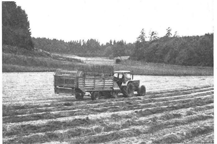
Abb. 3: Der Universal-Ladewagen Claas LWU ist — wie der Name sagt — mehr als ein konventioneller Ladewagen. Er kann durch Einbau von insgesamt 23 Messern auch als Silierwagen genutzt werden. Dosiertes Entladen nach hinten, nach links und nach rechts ist ebenfalls möglich.
