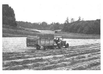
Abb. 3: Der Universal-Ladewagen Claas LWU ist — wie der Name sagt — mehr als ein konventioneller Ladewagen. Er kann durch Einbau von insgesamt 23 Messern auch als Silierwagen genutzt werden. Dosiertes Entladen nach hinten, nach links und nach rechts ist ebenfalls möglich.
