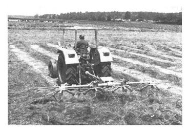
Abb. 1: Der Wirbelwender Claas W 450 ist eine Spezialmaschine zum Zetten und Wenden von Halmfutter. Gleichmässig und locker werden die Mähschwaden über die gemähte Fläche verteilt. Trotz grosser Arbeitsbreite von 4,50 m passt sich das Gerät Bodenunebenheiten sehr gut an, weil jeder der vier Grosskreisel durch ein eigenes Tastrad geführt wird.
