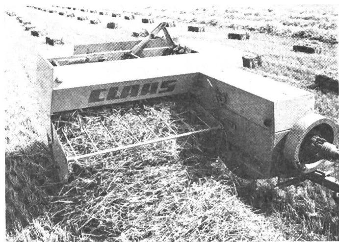
Die **Claas-Markant 60** wurde als leistungsstarke Hochdruck-Presse für Lohnunternehmer und Grossbetriebe konzipiert; sie leistet bis zu 18 t pro Stunde. Mit 1.80 m ist der Aufgreifer besonders breit. Engstehende Zinken und ein Durchmesser der Pickup-Trommel von nur 420 mm garantieren die rechensaubere Aufnahme auch breiter Schwaden. Funktionssicher und wartungsarm sind die Doppelkurbel-Zubringer mit je drei Zinken, die das Pressgut in die
