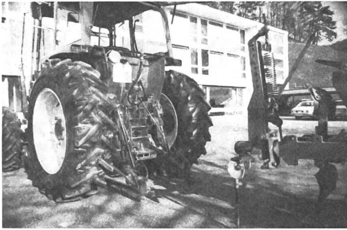
Abb. 4: Beim WKS-Kuppler erfolgt zuerst das Kuppeln der Unterlenker mit den Fanghaken über die Fangprofile am Gerät. Anschliessend wird der ebenfalls vom Traktor aus verkürz-, resp. verlängerbare Teleskopoberlenker eingehakt. Die Grobeinstellung des gekuppelten Oberlenkers wird ebenfalls vom Traktorsitz aus vorgenommen; eine eventuell nötige Feineinstellung geschieht über die Verstellung des Kugelgelenkkopfes.
