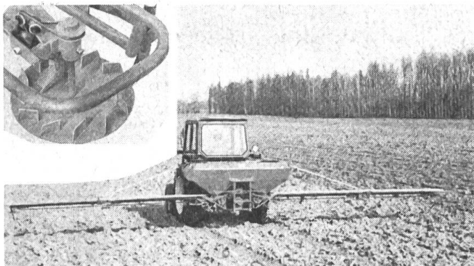
Abb. 4: Der neuartige Anbaudüngerstreuer «Lely» weist als Streuorgan einen Balken mit 6 Schleuderscheiben auf.
