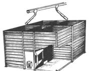
Getreide trocknen, lagern, belüften im AKRON-Lagersilo Typ M mit Fliessbodenentleerung.
