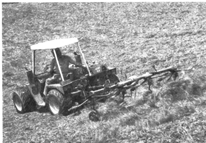
Abb. 2: Eine hangtaugliche Bereifung bietet Gewähr für die Schonung des Bodens, für möglichst geringe Futterschmutzung und beim Wenden für geringe Bröckelverluste.
