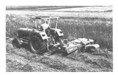
Abb. 2: Dreipunkt-Kreiselmäher «KM 22 C» mit Quetscheinrichtung bei der Arbeit. Werkfoto: Fa. Klöckner-Humboldt-Deutz AG; Zweigniederlassung Fahr; D-7702 Gottmadingen. -u-i-
