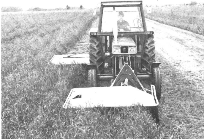
Abb. 1: IHC-Traktor mit Front- und Heckrotormäher im Einsatz; dadurch Arbeitsbreite von über 4 m. Werkfoto: Fa. International Harvester Company mbH; D-404 Neuss.
