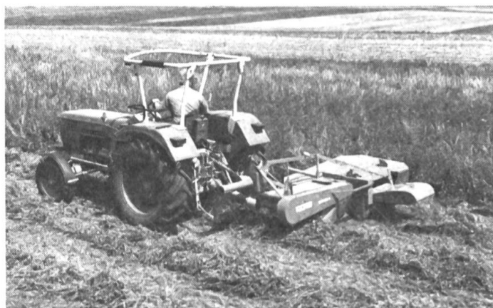
Abb. 2: Dreipunkt-Kreismäher «KM 22 C» mit Quetscheinrichtung bei der Arbeit. Werkfoto: Fa. Klöckner-Humboldt-Deutz AG; Zweigniederlassung Fahr; D-7702 Gottmadingen. -u-i-
