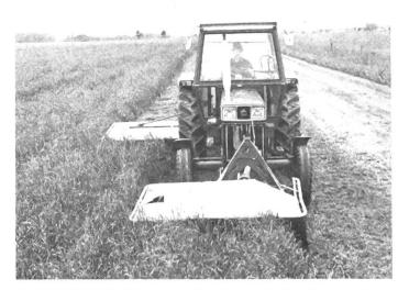
Abb. 1: IHC-Traktor mit Front- und Heckrotormäher im Einsatz; dadurch Arbeitsbreite von über 4 m. Werkfoto: Fa. International Harvester Company mbH; D-404 Neuss.
