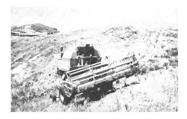
Sperry NEW HOLLAND hat in jahrelangen Versuchen einen Hangmähdrescher entwickelt der ähnlich arbeitet wie ein Kreiselkompass bei Schiffen. Die Maschine wird immer, ganz gleich welche Bewegungen die Räder machen, waagrecht gehalten. Der Ausgleich erfolgt vollautomatisch über folgenden Bereich:
