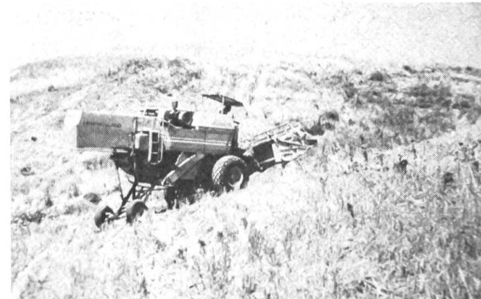
Eine Warnleuchte auf dem Fahrerstand signalisiert dem Fahrer, wenn die Ausgleichsgrenze erreicht ist. Eine elektrische Hand-Schaltung gestattet es, das automatische Ausgleichs-System zu übersteuern. Die Hand-Schaltung kann sich als praktisch erweisen,
