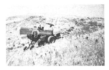
Eine Warnleuchte auf dem Fahrerstand signalisiert dem Fahrer, wenn die Ausgleichsgrenze erreicht ist. Eine elektrische Hand-Schaltung gestattet es, das automatische Ausgleichs-System zu übersteuern. Die Hand-Schaltung kann sich als praktisch erweisen, wenn z.B. die Korntank-Entleerungsschnecke näher an einen Anhänger herangebracht werden soll. Generalvertretung:
