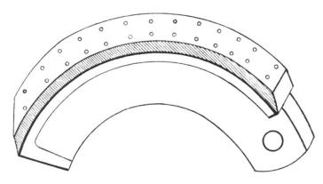
Bremsbacke mit Bremsbelag Bremsbelag aus Weichmetallfäden und durchflochtenem Asbestgewebe.
