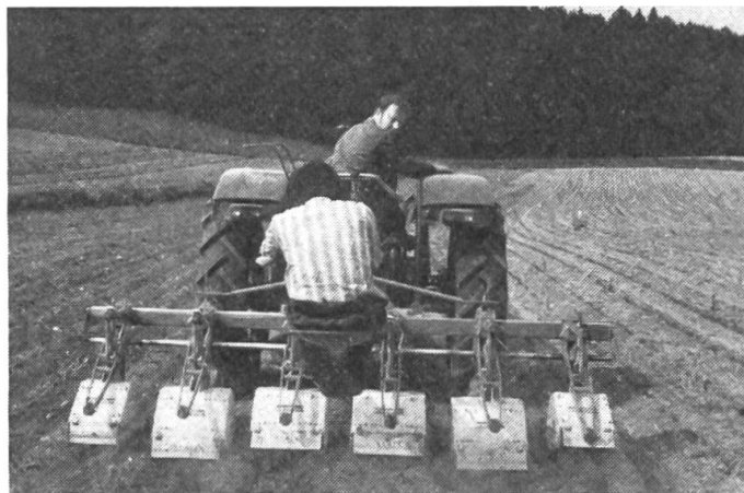
Abb. 4: Mit einer Mehrreihenfräse lässt sich nebst der Unkrautbekämpfung eine gründliche Oberflächenlockerung erreichen.
