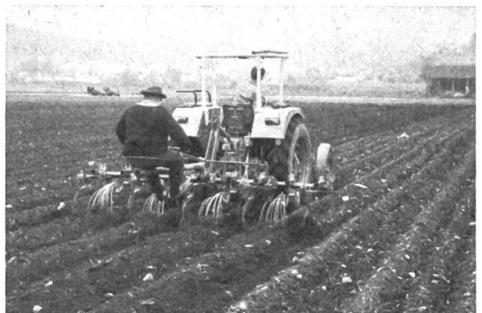
Abb. 1: Hacken und Striegeln mit einem Vielfachgerät. Mit einem geeigneten Kammstriegel lassen sich auch die Unkräuter im oberen Teil der Dämme bekämpfen.
