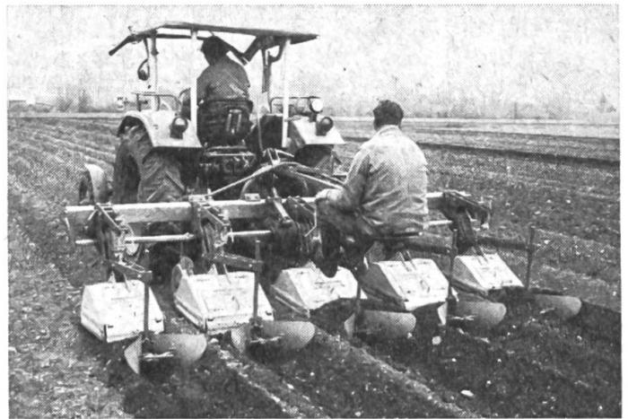
Abb. 4: Die Mehrreihenfräse liefert eine gute Hack- und Häufelarbeit.
