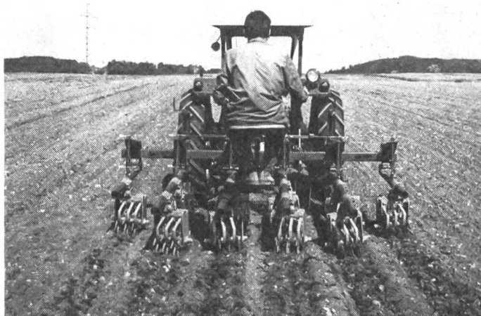
Abb. 3: Ein Sternhackgerät kann eher zur Beseitigung der verkrusteten Oberfläche als für eine Unkrautbekämpfung in Zuckerrüben eingesetzt werden.
