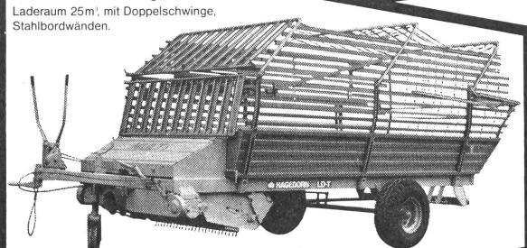
Dörrfutteraufbau mit stabilen Rechteck-Stahlprofilen (dadurch kompakte Bauweise und extrem tiefe Abklapp-Möglichkeit).
