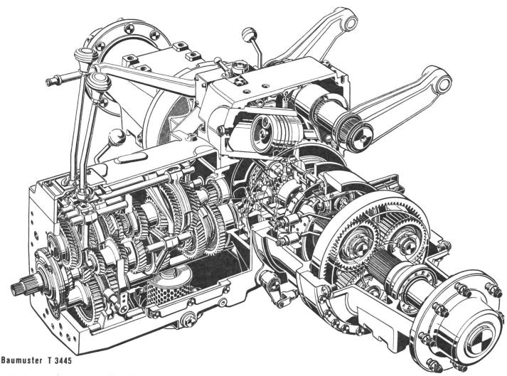
Abb. 1: Man kann eine Einteilung in Hauptbaugruppen vornehmen: Schaltgetriebe mit Nebenantrieben einschliesslich Kupplungen – Hinterachse – Kraftheber.
