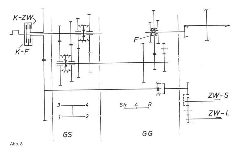
wandt, das Gruppengetriebe wird mit Schieberädern klauengeschaltet. Auf Grund des einfachen Aufbaues hat das Getriebe günstige Herstellkosten. Da nur 8 Vorwärtsgänge für einen echten Universalschlepper zu wenig sind, wurde die Möglichkeit geschaffen, durch eine wahlweise einbaubare Baugruppe mehr Gänge und Lastschaltung zu erreichen.
