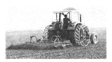
Abb. 2: Oben feinkrümelig — darunter fest und guter Bodenschluss; das ist das Ziel bei der Herrichtung des Zuckerrüben-Saatbettes. Federzahngrubber bzw. Garegge und Kombikrümler, exakt in der Bearbeitungstiefe eingestellt, schaffen hier das Zuckerrübensaatbett.
