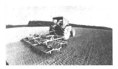
Abb. 1: Ein Ziel bei der Saatbettbereitung lautet: Wenig Schlepperspuren, da diese vor allem bei der Zuckerrübensaat den Feldaufgang auf diesen spurgeschädigten Bodenstreifen erheblich vermindern. Doppelreifen oder Gitterräder sind deshalb anzuraten.
