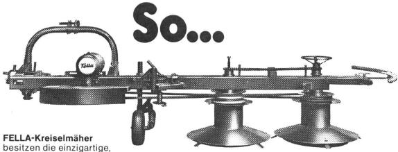
stufenlose Schnitthöhen-Schnellverstellung mittels obenliegendem Handrad. Die beidseitig verwendbar und drehbaren Teller gleiten über lassen sich spielend leicht alle Böden und schonen die Grasnarbe. Ein Doppelprofil-Keilriemen sorgt für störungs- schwenkt das Gerät um freien und geräuscharmen
