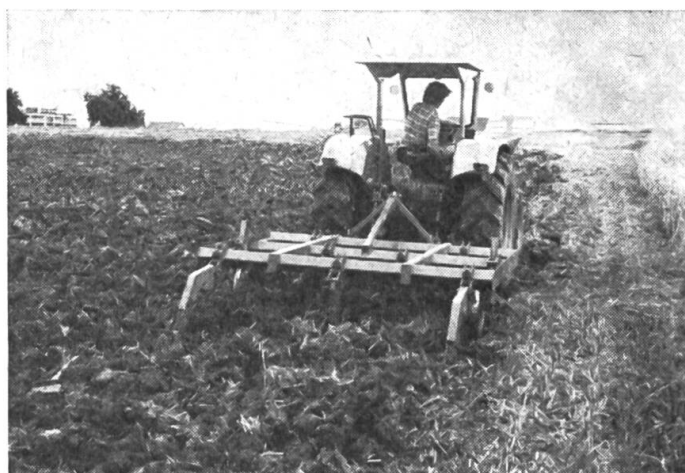
Abb. 16: Unter schwierigen Bedingungen oder bei knapper Traktorleistung empfiehlt es sich, entweder erst im zweiten Durchgang auf volle Tiefe oder mit reduzierter Zinkenzahl zu arbeiten. Die Meisselzinken lassen sich durch Entfernung des Sicherheits-Scherbolzens leicht ausschalten.
