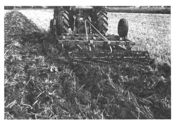
Abb. 11: Für die Bearbeitung der grobscholligen Struktur ist ein Nachfolgegerät, insbesondere in schweren Böden, zu wenig wirksam.
