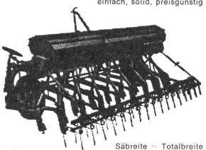
mit Normal- oder Scheibenscharen. Beidseitiger Antrieb, Saatauslauf nach vorne, zentrale Druckregulierung usw.
