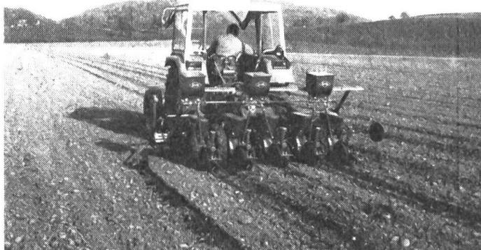
Abb. 3: Nach dem Unterdrucksystem konzipierte pneumatische Einzelkornsäugeräte eignen sich sowohl für die Saat auf Wechselabstände wie auch zur Erzielung von doppelt belegten Pflanzenstellen.
