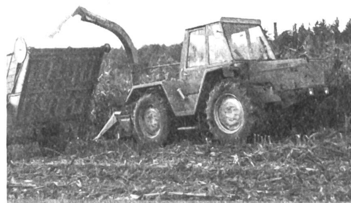
Abb. 5: Der 1014 mit 2-reihigem Maishäcksler in Schubfahrt: keine behelfsmässige Rückwärtsfahrt, sondern vollwertige Selbstfahrfunktion mit allen Vorteilen der Allrad-Lenkung (Hinterachslenkung). Hervorragende Abstufung der Geschwindigkeiten durch 16 Gänge auch in Schubfahrt, Getriebe voll belastbar.
