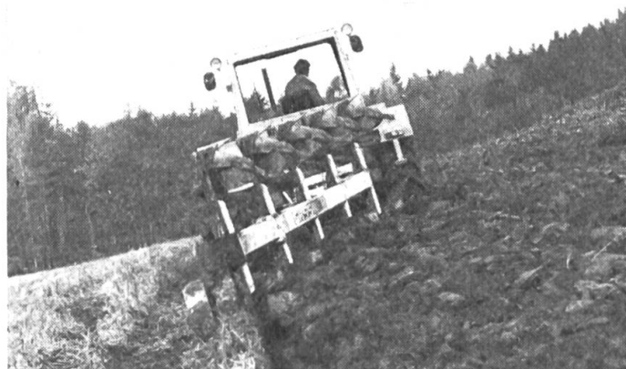
Abb. 4: Bei schwierigem Pflügen auf sehr schwerem Boden konnte der 1014 den grossen Vorteil des Hundeganges beweisen. Trotz erheblicher Hangneigung wurde die starke Abtrift durch die Hundegang-Lenkung aufgefangen.
