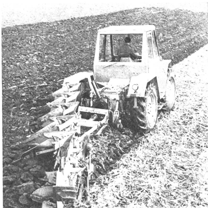
Abb. 2: Durch Allrad-Antrieb über 4 gleich «grosse» Räder, optimale Achslastverteilung, grosse Manövrierfähigkeit und praxisgerechte Getriebeabstufung, erfüllt der Zweiwege-trac höchste Anforderungen an einen Allrad-Traktor. Zugkräfte werden maximal übertragen.
