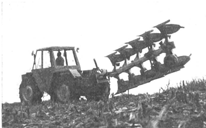
Abb. 3: Das rasche Wenden am Furchenende erstaunte allgemein. Ermöglicht wird es durch die Allrad-Lenkung und zwar auf kleinstem Raume (Spurkreisradius 3,15 m). Der Pflug mit 1,75 t Gewicht wird spielend ausgehoben. Der 1014 dreht mit diesem 5 m langen Pflug auf engstem Kreis, ohne durch die auftretenden enormen Fliehkräfte auch nur im geringsten innen abzuheben.
