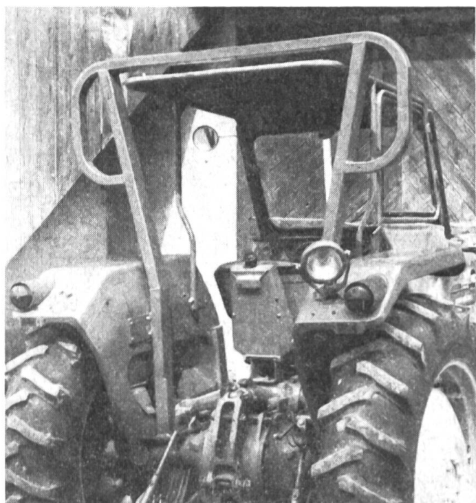
Abb. 3: Sicherheitsbügel mit oben abgerundeter Querverbindung.
