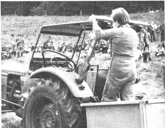
Abb. 2a: Abklappbarer Bügel für Normaltraktor. Man beachte das gelochte Segment oberhalb des Kot- flügels. Es gibt auch Ausführungen, bei welchen das Segment im oberen Drittel angeordnet ist. Die erst- erwähnte Lösung ist für das Durchfahren von Obst- anlagen, die andere zur Anpassung an geringe Durchfahrtshöhen bestimmt.
