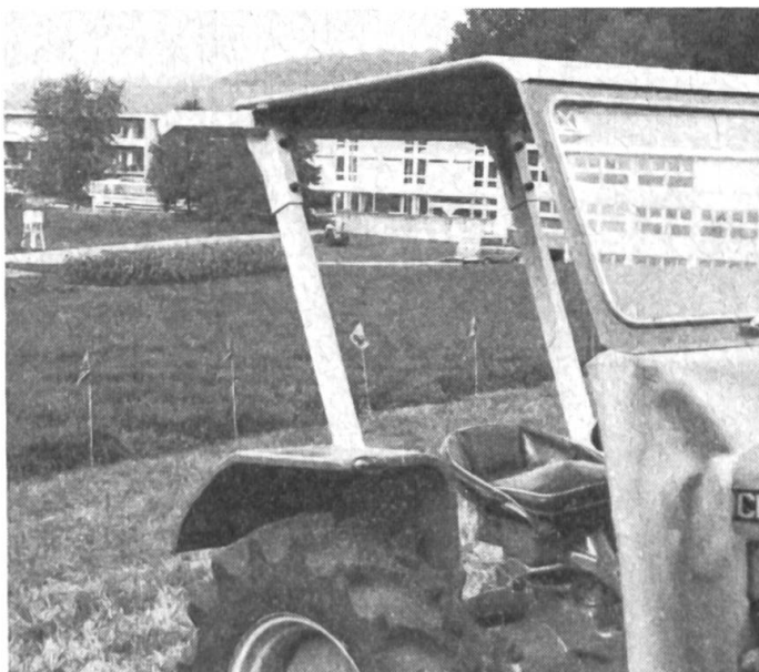
Abb. 4: Bügel verbunden mit dem Gestänge des Wetter-Schutzverdeckes. So kombiniert wirkt der Fahrerschutz auch als Blitzschutz.
