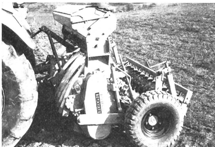
Abb. 6: Bei Stellung der Saatgutleitungen vor der Fräswelle werden die Samen ziemlich gleichmässig über die Fläche verteilt, jedoch verschieden tief eingefräst (Bestellbreitsaat).
