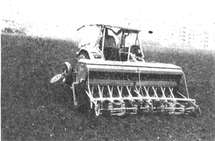
Abb. 2: Bandsaat von Winterweizen mit der Sämaschine Tume. Das Zudecken der Samen und Ausbennen der Oberfläche erfolgt über zwei Stab-Krümlerwalzen.
