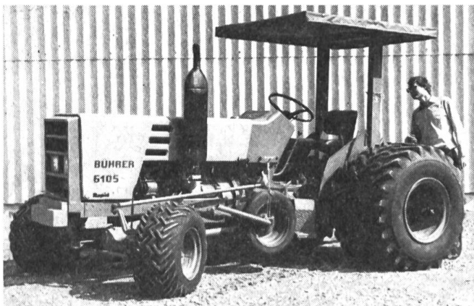
Abb. 5: Standardtraktor mit versuchsweise montierter Terrabereifung.
