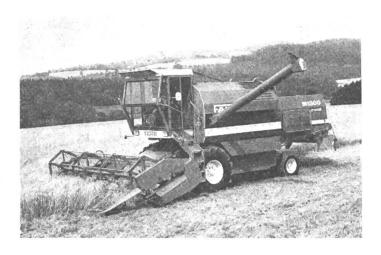
ausrüstung mit einer Arbeitsbreite von 4,95 m geliefert. Es sind aber auch schmälere und breitere Mähwerke erhältlich.
