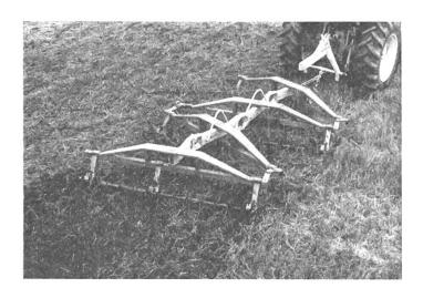
auf hartem Boden und bei hohen Geschwindigkeiten ein imponierendes Eigengewicht und reichlich Zusatzbelastung. Mit Hilfe der Hydraulik lässt sich die Egge trotz ihres grossen Gewichts und ihrer Arbeitslänge mühelos hantieren. Zum Transport lässt sich die Egge «zusammenfalten». Der Schwerpunkt der Egge befindet sich dann so nah am Trecker, dass Lenkeigenschaften und Handhabung nicht negativ beeinflusst werden.
