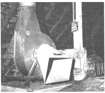
Abb. 1: Der kleine Schaltkasten neben dem Gehäuse enthält staubsicher verpackt alle Steuerelemente.
