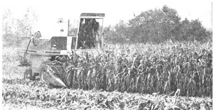
Abb. 2: Für den Körnermaisdrusch haben sich die Pflückvorsätze bewährt, die heute schon sechs- und achtreihig angeboten werden; das erfordert allerdings eine hohe Motorleistung sowie leistungsfähige Siebe und Schüttlerorgane.
