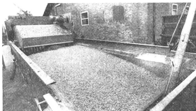
Abb. 4: Bei dieser Flachtrocknung, die sehr schonend trocknet und auch bei Getreide, Gras usw. einzusetzen ist, sorgt das vor- und rückwärts laufende Schaufelwerk für eine gleichmässige Trocknung; es fördert gleichzeitig das Trocknungsgut zur Kühlzone und zum Auswurfende.
