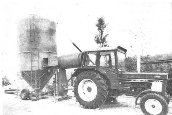
Abb. 5: Auch für den überbetrieblichen Einsatz beim Lohnunternehmer oder in Maschinenringen ist dieser fahrbare Umlauftrockner geeignet, dessen Förder- einrichtungen durch den Schlepper angetrieben werden.
