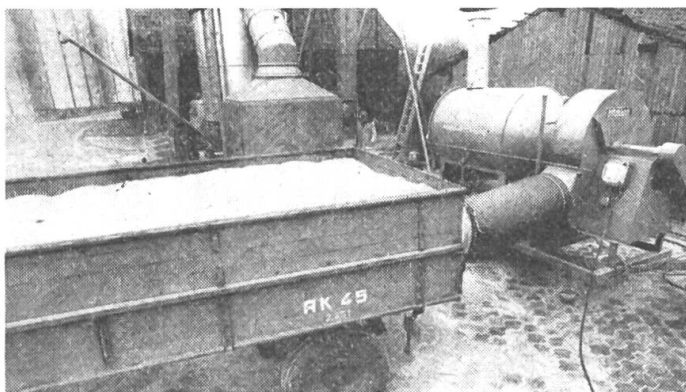
Abb. 3: Die Wagentrocknung mit angeschlossenem Wärmeofen ist nicht ortsgebunden und auch relativ gering in der Investition; es sind keine baulichen Massnahmen erforderlich. Zur Entleerung empfehlen sich Zweiseitenkipper.
