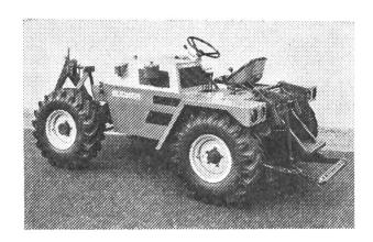
chende Anordnung von Motor, Getriebe und Fahrersitz konnte bei optimaler Tiefhaltung des Schwerpunktes eine sehr gute Bodenfreiheit erzielt werden. Diese erweist sich als vorteilhaft bei Wald- und Ackerbauarbeiten.
