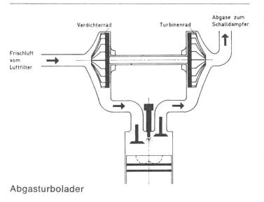
Um die gleiche Betriebssicherheit, günstigeren Treibstoffverbrauch bei Vollast und bei Teillast als beim normalen Saugmotor zu erreichen, ist es unbedingt notwendig, die Motoren regelrecht für die Ausrüstung mit Abgas-Turbolader zu konstruieren.
