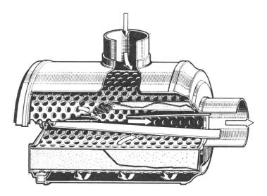
Eine Abschätzung des Wartungszeitpunktes aufgrund des Staubbelages auf der Papierpatrone ist nicht möglich, dies kann nur mit einem Wartungsanzeiger der auf den Durchflusswiderstands-Höchstwert eingestellt ist, zuverlässig bestimmt werden.
