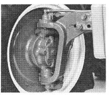
Ein neuer hydrostatischer Frontantrieb – auf Wunsch bei den Typen 2130 und 3130 – ermöglicht zuverlässiges Arbeiten selbst unter schwierigsten Bedingungen. Scheibenbremsen im Ölbad mit hoher Bremskraft erhöhen die Manövrierfähigkeit.
